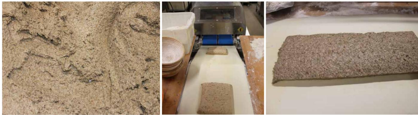
Roggen mit Rheon: Der Teig für das Schwarzbrot aus 100 Prozent Roggenmehl mit TA 170 und Quellstück aus mittelscharfem Schrot. Kein Problem für die Rheon: Einwandfreier Durchlauf und exakt abgeteilte Teigstücke – ideal zur weiteren Formung per Hand.
