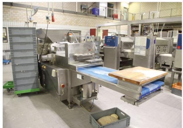
Die Rheon-Abwiegeanlagen lassen sich mit vielen verschiedenen Elementen von bmTEC optimal erweitern, wie etwa mit verschiedenen Stanzwerkzeugen
