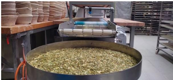
Erweitert wurde das System durch einen Tisch sowie eine Befeuchtungsanlage und eine Saatenstation von bmTEC
