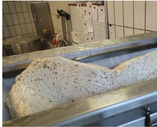
Portionsweise wird der Teig von den Mitarbeitenden in die Anlage eingefüllt und läuft dann sauber durch den Trichter nach innen, wo er abgewogen wird
