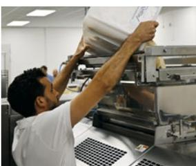
Stürzen des gesamten Teiges am Start einer modular aufgebauten Produktionslinie
