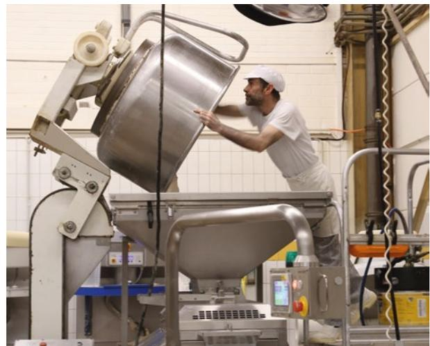
Ein Heber erleichtert das Arbeiten für die Mitarbeitenden. Der Kessel kann bequem hoch gefahren werden und das Personal muss weder schwer heben noch sich bücken
