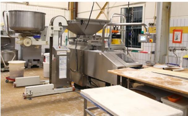
Die brandneue Rheon Twin Divider Teigbandanlage musste nicht lange eingefahren werden und lieferte sofort die dem Betrieb bereits bekannte Genauigkeit und schonendes Abwiegen
