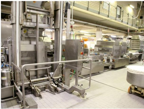
Hebesysteme erleichtern das Befüllen der Rheon mit Teig deutlich. Das freut vor allem die Mitarbeitenden, denn so kann der Kessel direkt an die Anlage gefahren und automatisch entleert werden. Und das ohne schweres Heben oder mehrfaches Bücken und Strecken
