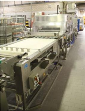
Mit Rheon wird nicht nur abgewogen; der Cup Rounder ermöglicht zusätzlich das schonende Rundwirken von Teiglingen. Dieser Aufbau ist kompatibel mit der dahintergeschalteten Kövy-Brötchenstraße
