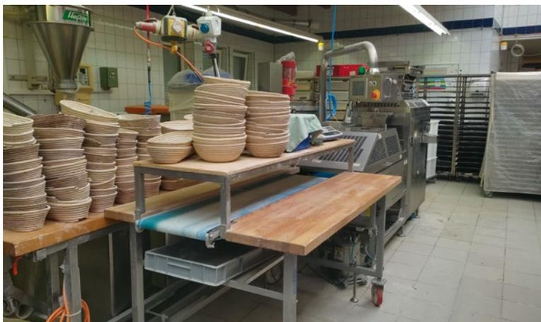
Der Rheon Twin Divider zog im November 2023 in die Backstube ein. In der Produktion ersetzt der moderne Abwieger zwei ältere Maschinen und ist spürbar leistungsfähiger als sie
