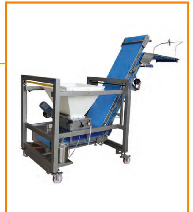
Gerne passen wir unsere Konstruktion Ihren Gegebenheiten an, wie in diesem Beispiel, bei dem mit einem Hebekipper über die Zuführbänder zwei Rheon Kopfmaschinen beschickt werden.
