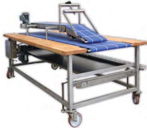
Arbeits-tisch mit Oberband zur manuellen Bestückung vor automatischem Absetzer
