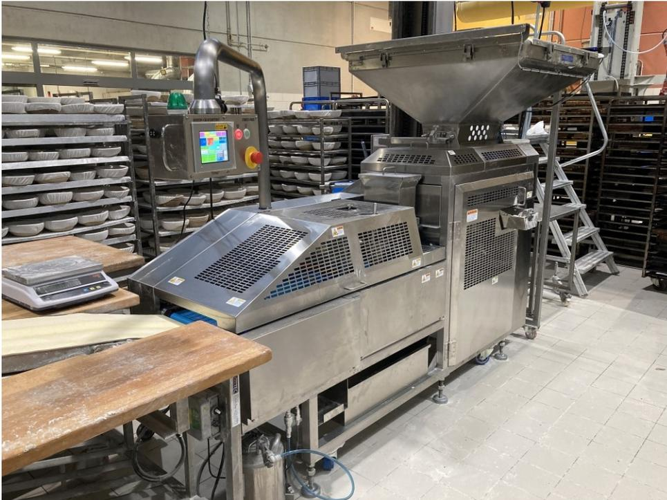
Rheon Twin Divider mit Anpassung an Hebekipper
