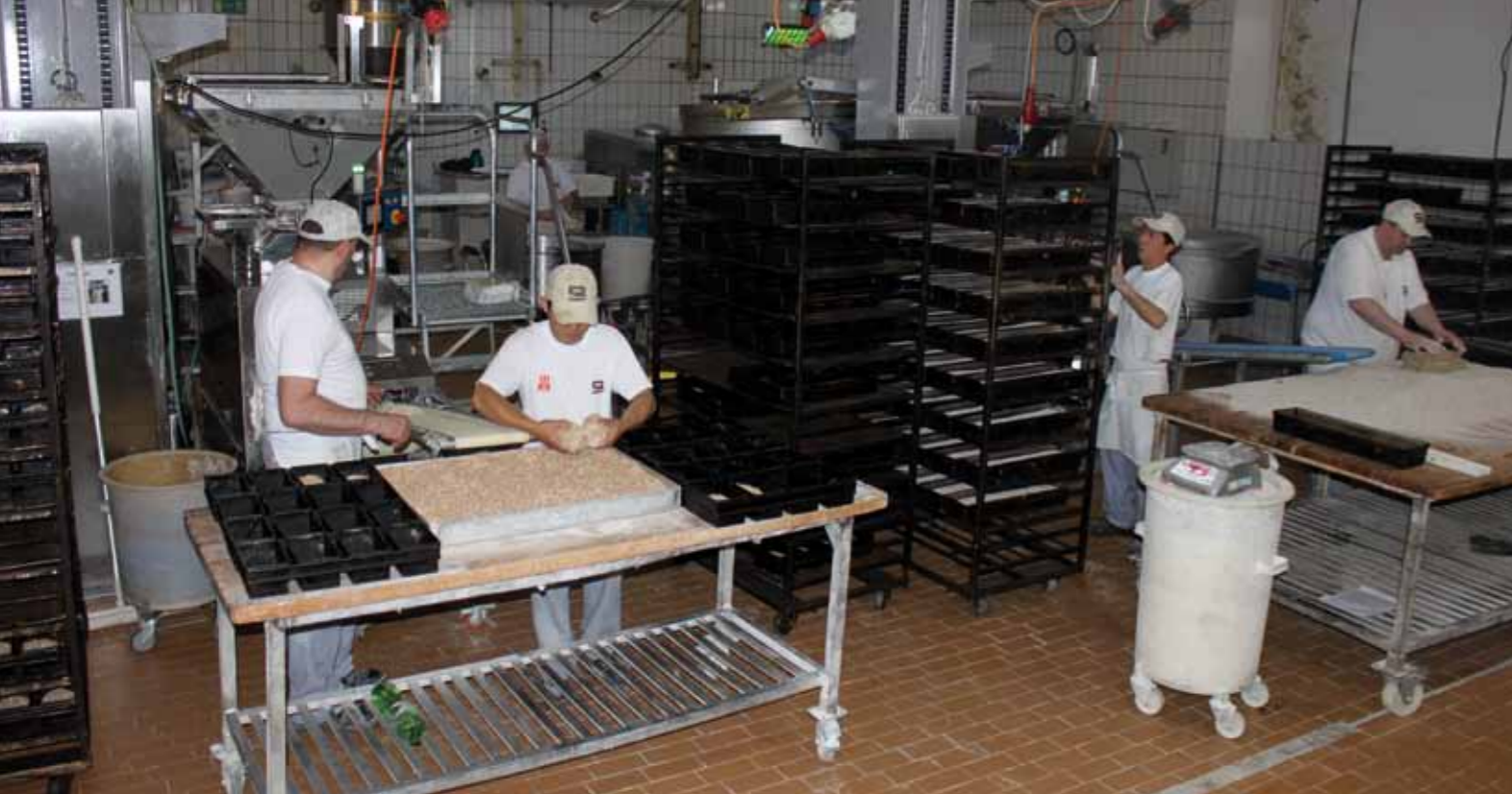
Hohe Stückzahlen: Eine Rheon beschäftigt je zwei Mitarbeiter: Links weicher, klebriger Dinkelteig, rechts der breiförmige Schrotteig: Beide Brotsorten lassen mit normalen Teigteilern und nachgeschalteten Bausteinen einer automatisierten Brotherstellung (Kegelförmiger, Bänderwirker oder Langroller) nicht aufarbeiten.
