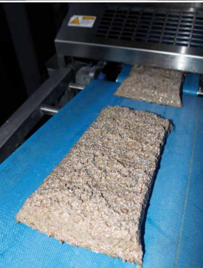
Sogar aus einem ja eher breiförmigen Schrotbrotteig mit geringer Bindigkeit im Teiggerüst vermag der Rheon V4-Abwieger ein stabiles Teigband zu erzeugen und portioniert in absolut gleichmäßige Stücke, exakt verwogen – sensationell! Das dürfte in Sachen Leistungsvermögen eines Teigbandformers am Markt seines gleichen suchen.
