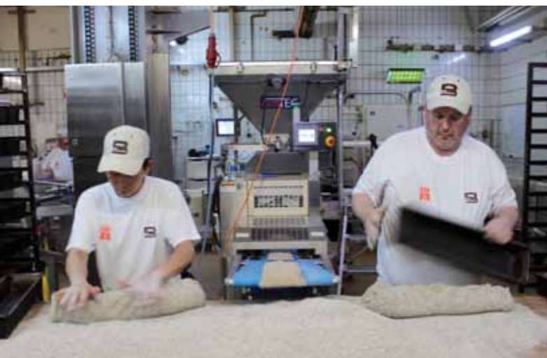
Großbrote für den scheibenweisen Verkauf in den Fachgeschäften: Nach dem Wälzen in Roggenschrot geht's ab in die Kästen: Die Schrotbrote würden freigeschoben natürlich breitlaufen.
