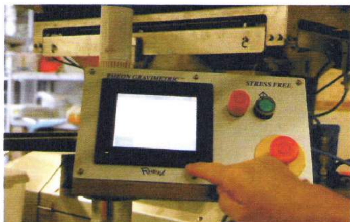
Im Display kann die Produktliste mit allen programmierten Varianten für den Teigteiler aufgerufen werden.
