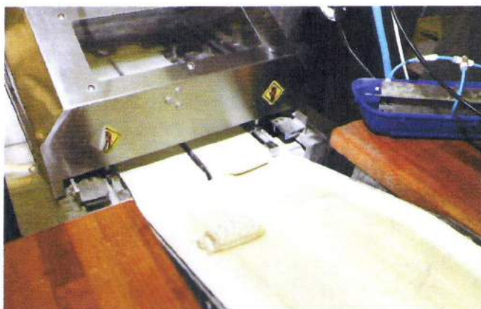
Mit einem oder zwei Messern werden die Teigportionen vom „Twin Divider“ hinter Glas grammgenau geteilt.
