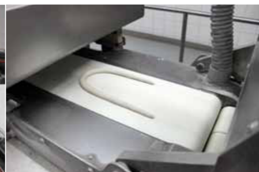
Perfektes Ergebnis: Der Strang mit stattlicher Länge zeigt nicht einen einzigen Riss an der glatten Oberfläche.
