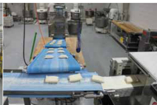
Clevere Lösung: Non Stop laufen die Teigstücke über offene Transportbänder ohne Zwischengare direkt in den Brezelschlinger.
