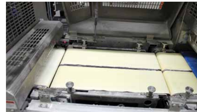
Für die hohe Gewichtsgenauigkeit beim Abwiegen sorgen zwei unabhängig arbeitende Wiegezellen im Transportband integriert.
