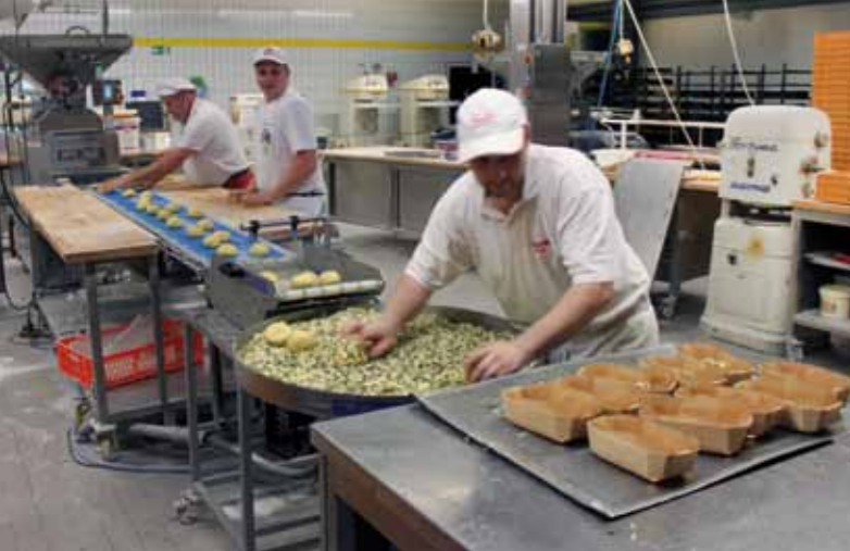
Mensch und Maschine Hand in Hand: Nach dem Teilen und Abwiegen durch die Rheon wird jedes Brot von Hand aufgearbeitet.
