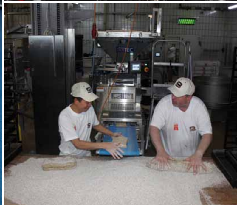
Sogar aus einem ja eher breiförmigen Schrotbrotteig mit geringer Bindigkeit im Teiggerüst vermag der Rheon V4-Abwieger ein stabiles Teigband zu erzeugen und portioniert in absolut gleichmäßige Stücke, exakt verwogen – sensationell! Das dürfte in Sachen Leistungsvermögen eines Teigbandformers am Markt seines gleichen suchen.
