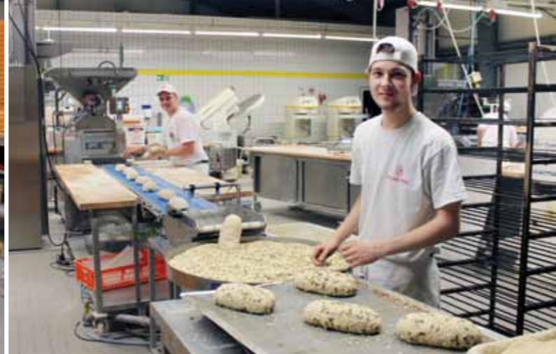
Mensch und Maschine Hand in Hand: Nach dem Teilen und Abwiegen durch die Rheon wird jedes Brot von Hand aufgearbeitet.
