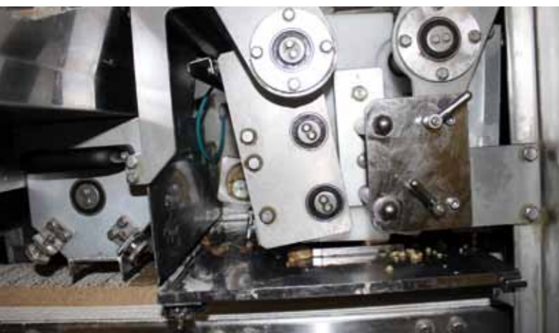
... formt der Rheon V4-Abwieger mit seinem einzigartigen V4-System dank spezieller Walzenpaare ...
