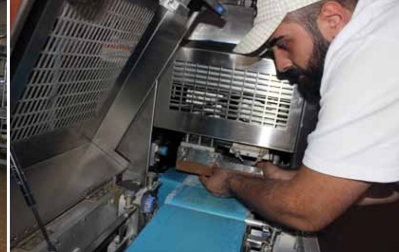
Schneller Wechsel: Für die Schrotbrotteige wird eine spezielle Guillotine mit automatischer Beülung eingesetzt. Alle anderen Teige meistert die Rheon ohne Beülung.
