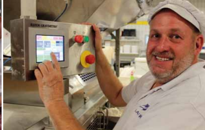
Bei Produktwechseln, etwa von Brötchen auf Brote, erfolgt die Umstellung an der digitalen Steuerung schnell und bequem per Programmaufruf. Dank einfacher und übersichtlicher Menüführung lassen sich Parameter einzelner Rezepte bei Bedarf leicht umstellen oder an die Teigkonsistenz der Charge anpassen.
