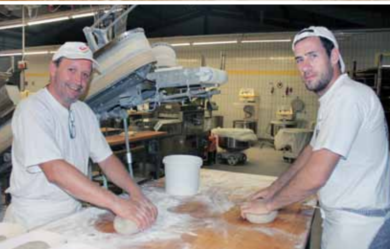
Roggenmisch- und Roggenteige laufen bei Tiedemanns über die Rheon: Je nach Teigkonsistenz wird für das Vorformen dann auch bei einigen „Standardbroten“ ein Bänderwirker eingesetzt, bevor das eigentliche Rund- und Langwirken in Handarbeit erfolgt.
