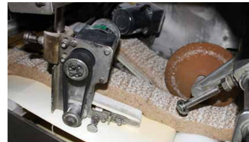
Auch das präzise Teilen – längs per Walze und anschließend quer per Guillotine – erfolgt außerordentlich schonend.
