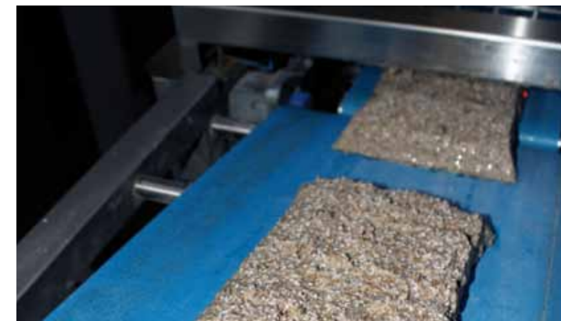
Der V4 Abwieger kennt beim Einsatzspektrum keine Grenzen: Reiner Roggenschrotbrotteig exakt portioniert. Je nach Teigart und Konsistenz variieren die Teigstücke in Form und Länge: Stets wird das gewünschte Gewicht und die ideale Form zur Weiterverarbeitung erreicht.
