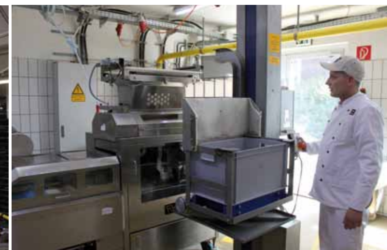
Bis zu 24 Stunden Teigreife: Im Weizenbereich reifen viele Teige über Nacht in Wannen – auch hier geht's in kleineren Chargen per Wannenkipper automatisch in den Trichter der Rheon.
