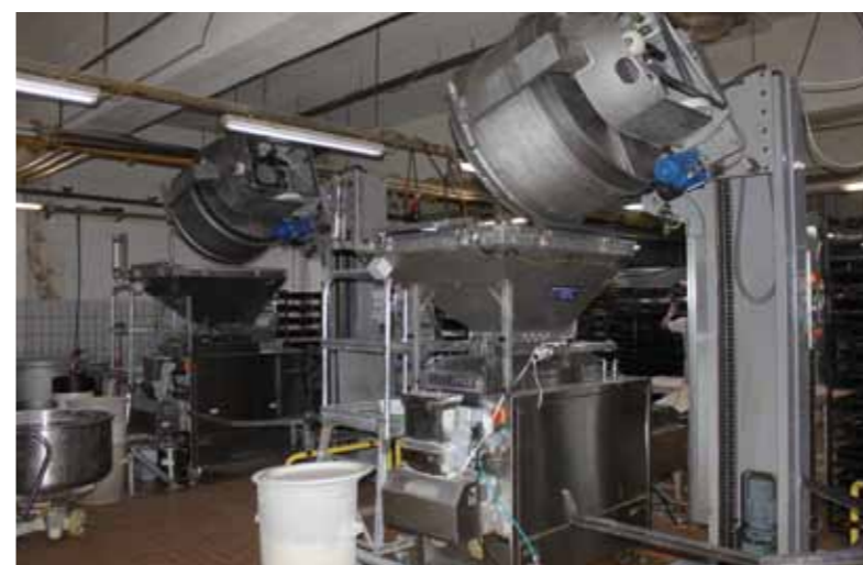
Hoher Rationalisierungsgrad – effektive Arbeiterleichterung: Per Hebekipper fließen die großen Teigchargen in den Trichter, der sich dank Spezialkunststoff rückstandslos leert.
