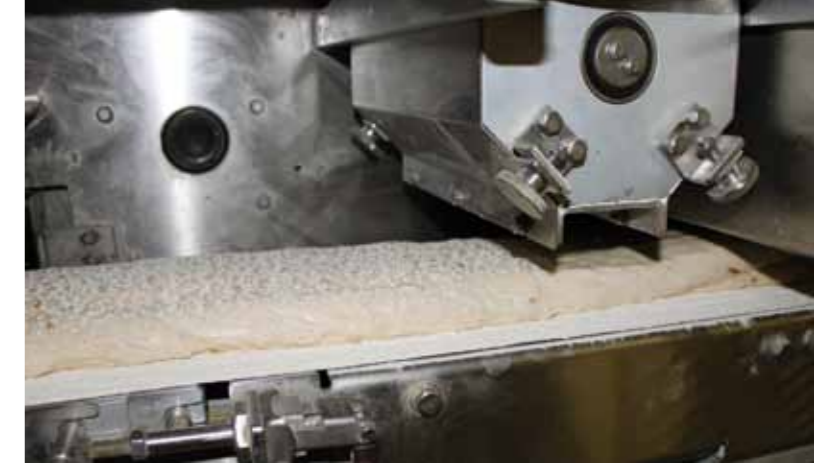
... ein kontinuierliches, sehr gleichmäßiges Teigband, ohne die Teigstruktur zu zerstören.
