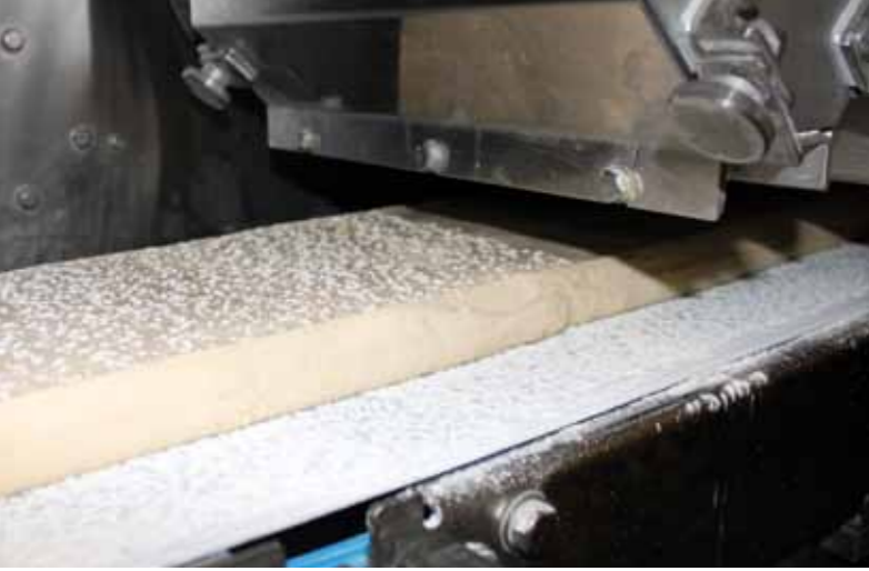
Basis für Qualität und Gewichtsgenauigkeit: Durch die spezielle Anordnung der Walzenpaare kann das V4 System ein extrem gleichmäßiges Teigband formen – aus jedem Teig.
